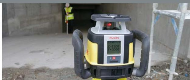
**HORIZONTALER, VERTIKALER UND VOLLAUTOMATISCHER DOPPELNEIGUNGSLASER MIT DIREKTEINGABE**
