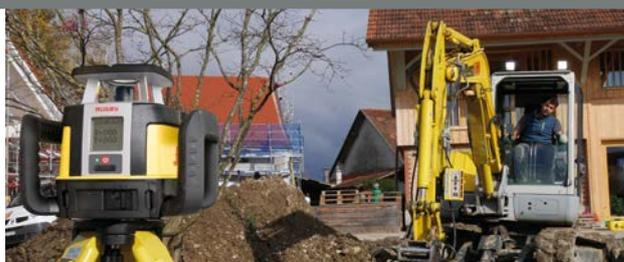
**HORIZONTALER, VERTIKALER UND VOLLAUTOMATISCHER DOPPELNEIGUNGSLASER MIT DIREKTEINGABE UND MASCHINENKOMPATIBILITÄT**
